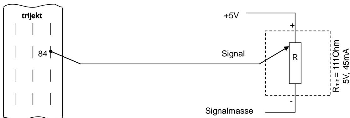
Das Poti muss so angeschlossen werden, dass die Signal-Spannung ansteigt, wenn die Drosselklappe geöffnet wird.
