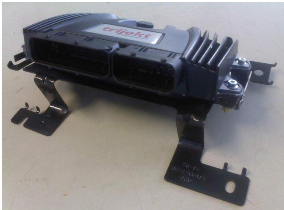
Die originalen Befestigungslaschen werden nach außen gebogen, so dass sich die Auflagefläche für das Steuergerät vergrößert. Nun kann es auf dem Halter befestigt werden.
