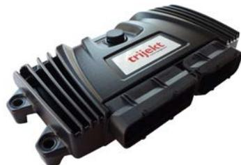
Verbauen Sie das Steuergerät am originalen Einbauplatz. Dieser befindet sich in der Regel vorn im Wasserkasten. Montieren Sie es in leicht erhöhter Position, um es vor intensiver Feuchtigkeit zu schützen. Idealerweise erfolgt die Montage direkt auf dem originalen Halter, der hierfür nur leicht modifiziert werden muss.
